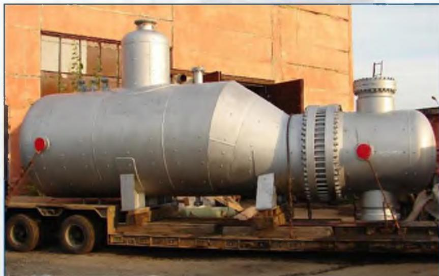
Блоки технологические предназначены для объектов газовой, нефтяной и смежных отраслей промышленности, работающие под давлением до 10,0 (100) МПа (кгс/см<sup>2</sup>), под вакуумом с остаточным давлением не ниже 665 Па (5 мм.рт.ст.) без давления (под налив) при температуре стенки не ниже минус 700С
